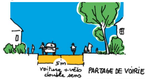
CHAUSSEE À VOIE CENTRALE BANALISÉE (CVCB)
